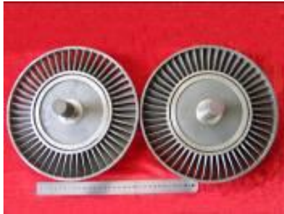
图 4 耐热合金-耐热钢涡轮盘
