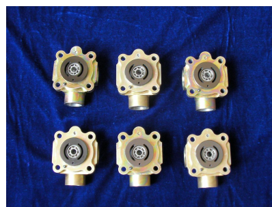
等离子体基离子注入与沉积整体处理的精密部件
