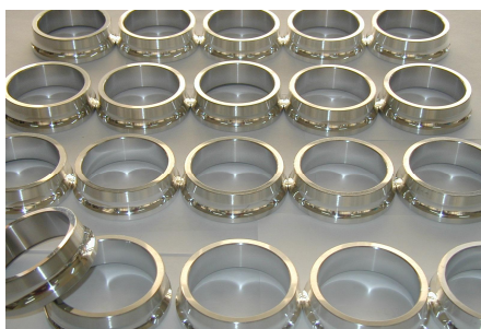
等离子体基离子注入与沉积处理的高速精密轴承
